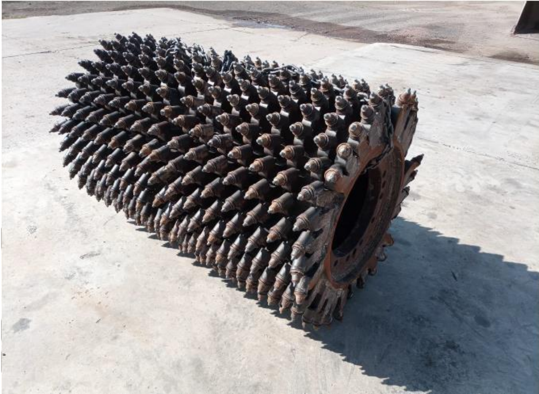
Rotor de 150 mm para micro perfilado
